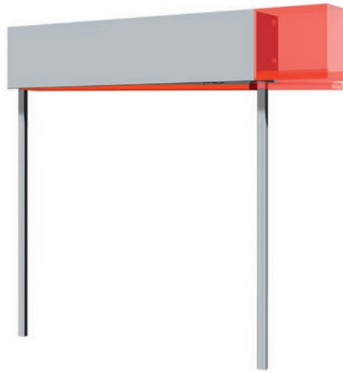
Bild 13: Veränderte Endlagenposition der Unterschiene (Unterschiene schief), Lamellenpaket einseitig sichtbar
