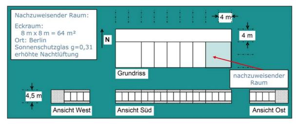
Bild 2 Geometrie des Gebäudes mit einem kritischen Raum für die Rechnung in Tabelle 1
