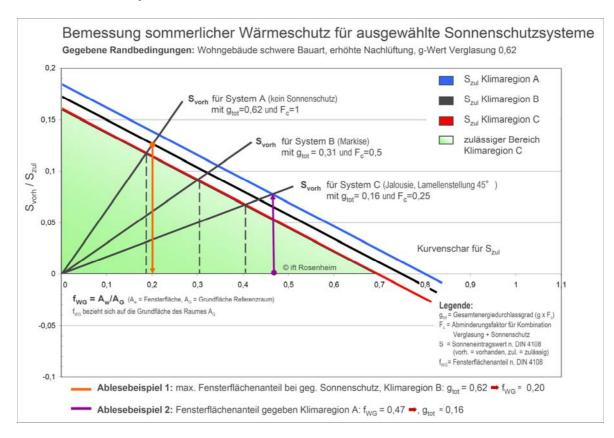
Bild 4 Diagramm zum grafischen Nachweis des erforderlichen Sonnenschutzes mit folgenden Randbedingungen (Wohnungsbau, schwere Bauart, erhöhte Nachtlüftung mit Luftwechsel Glas mit Gesamtenergiedurchlassgrad g = 0,62, Fensterneigung Fensterorientierung Ost über Süd bis West, keine bauliche Verschattung, keine passive Kühlung, weitere Diagramme in der ift Fachinfo WA/21/1 (Diagrammentwicklung M. Rossa, ift Rosenheim)
